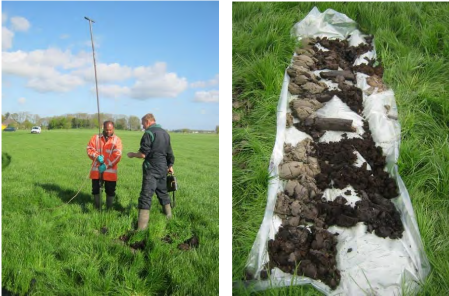
Figuur 4.8 Boring in perceel 1a, in de rechterfiguur het boorprofiel van boring WL1-B06 met links de kleibovengrond en rechts het veen (donkere kleur)
